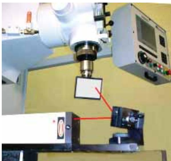
è puntato lungo la direzione diagonale; invece di muovere gli assi x, y e z in maniera continua nella direzione diagonale, la macchina è ora programmata per muovere l'asse x, fermarsi, acquisire il dato, muovere l'y, fermarsi, acquisire il dato e poi muovere l'asse z, fermarsi e acquisire il dato. Il processo continua fino a che non è stato raggiunto lo spigolo opposto; per questo è chiamato metodo di misura diagonale sequenziale per passi.
