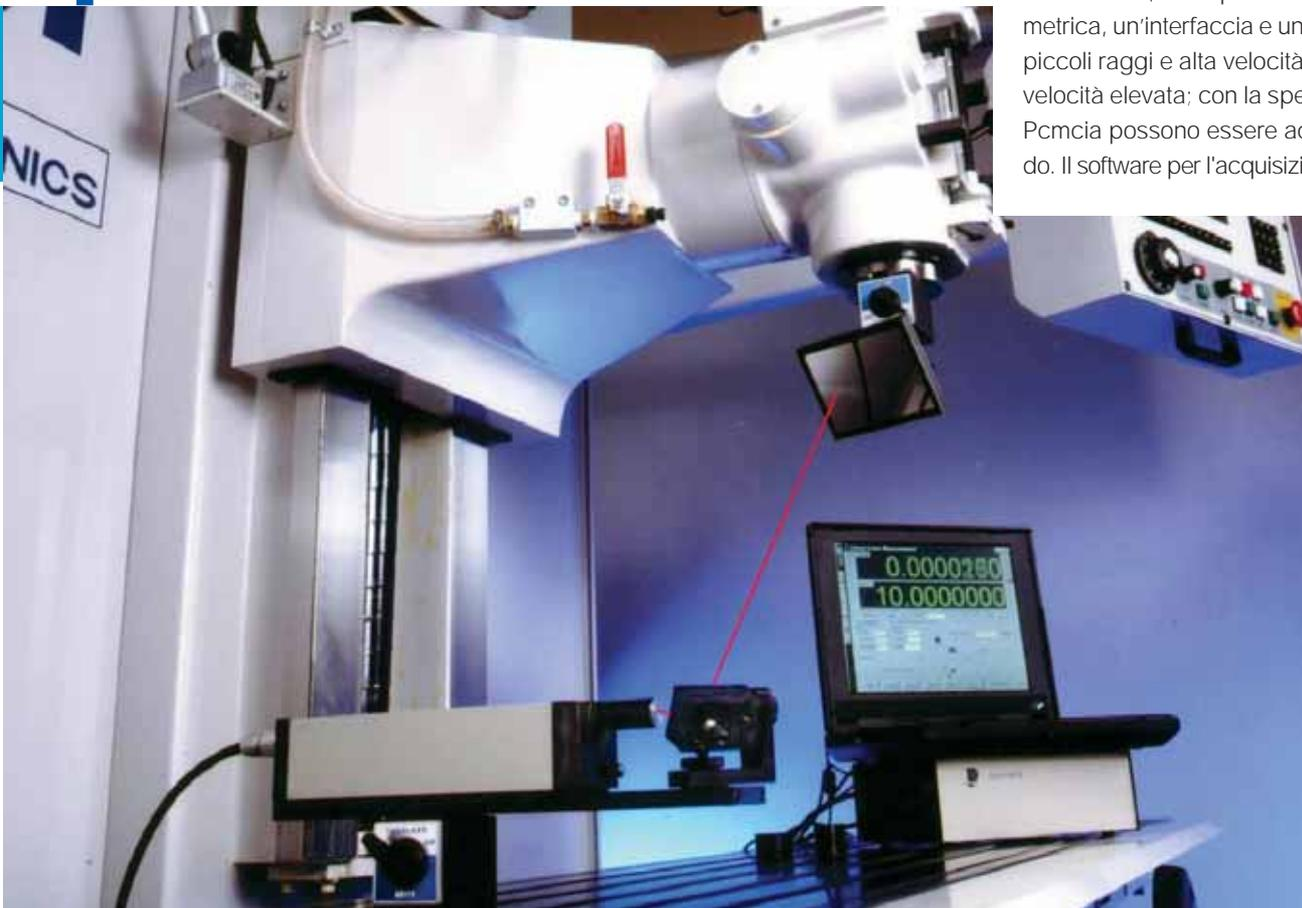
Optodyne ha realizzato un sistema laser per la misura volumetrica e la compensazione di errori di quadratura e rettilineità oltre che per misure senza contatto di coordinamento circolare e dinamica.
